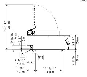
Drain Electrical inlet (power) ΕI Equipotential screw Water inlet
